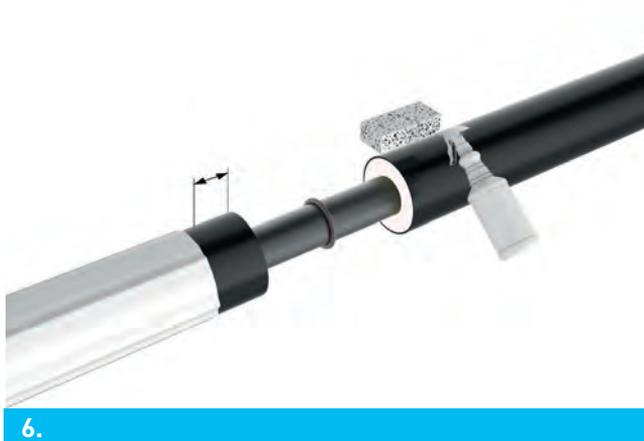
Mit dem Dreikantschaber an den Rohrenden arbeiten, um Schmutz und ähnliche Fremdkörper auf der Abdichtungszone zu beseitigen. Drähte des Überwachungssystems verbinden, wenn vorhanden.
