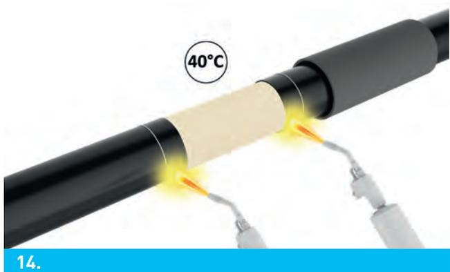
Mit einem Propangasbrenner bei leichter Flamme ~100 mm des Polyethylens auf jedem Ende des freien Rohrendes auf 40 °C erhitzen. Dabei darauf achten, die Dämmung und das Polyethylen selbst nicht zu überhitzen.
