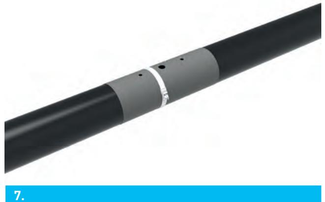
Die Schalung am Scheitel der Verbindung so positionieren, dass sich das Füll Loch auf dem obersten Teil der Kupplung befindet. Schalung durch die mitgelieferten Gurte befestigen.
