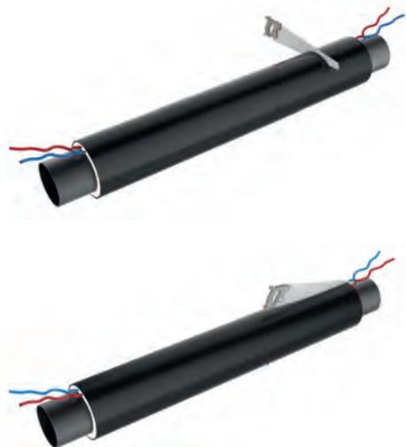
Ein Winkelschleifer darf auch zum Einsatz kommen, falls das Stahlrohr auch zu schneiden ist. Besonders sorgfältig soll man beim Schneiden der Rohre, die mit Überwachungsdrähten ausgestattet sind, vorgehen. Nachdem der Polyethylen Mantel geschnitten und entfernt worden ist, soll der Polyurethan Hartschaum mit einem passen-
