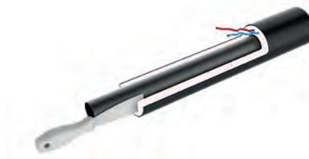
Die Überwachungsdrähte sollen in gutem Zustand bleiben und jede Spur des Polyurethan Schaums ist zu beseitigen. Die Überwachungsdrähte freisetzen, sie abschneiden, Schaumrückstände mit Schleifpapier beseitigen. Stahlrohr abschneiden, Stirnverbindung vorbereiten, indem die Anfasung des Rohres neu gemacht wird.
