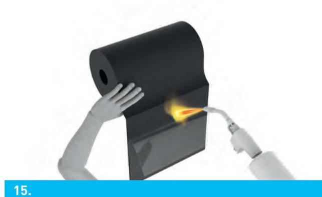
Einen Teil der Schutzfolie entfernen und die Schrumpffolie 150 mm vom Rand aufheizen.
