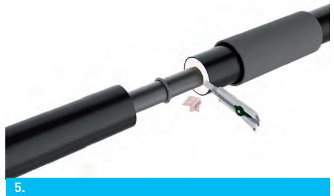
Sämtliche durchnässten Polyurethan Bereiche am Ende der vorisolierten Rohrleitung beseitigen.
