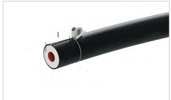
Entfernen Sie die Ummantelung des Rohres mit Hilfe einer Bügelsäge oder eines Rohrschneiders und heben Sie sie an. Achten Sie darauf, dass Sie das Innenrohr nicht schneiden (Bild 3). Abschließend entfernen Sie die Polyurethanschaumschicht und achten darauf, dass die Sauerstoffdiffusionsbarriere nicht beschädigt wird (Bild 4).
