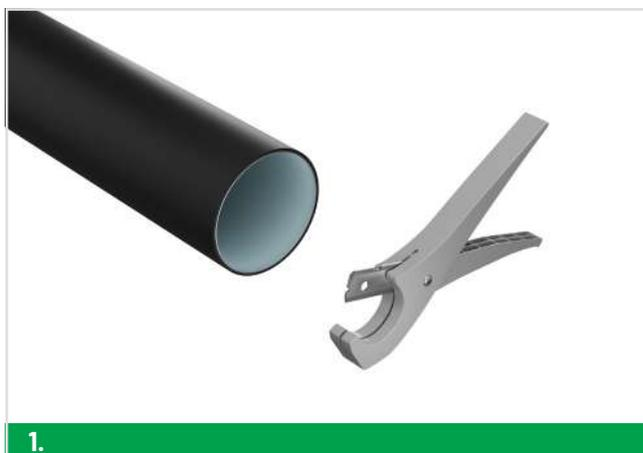
Taglia il tubo in modo dritto e rimuovi con attenzione lo strato isolante. Durante tutto il processo di installazione, assicurati di non danneggiare lo strato esterno PP e/o i filamenti dello strato di fibra aramidica.
