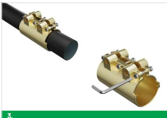
Rimuovi il bullone di serraggio, allarga la boccia di bloccaggio con una chiave a brugola utilizzando tutti i bulloni di apertura e inseriscila nel tubo come mostrato.
